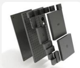
A l'image d'un Lego, le Phonebloks est un téléphone constitué d'un assemblage de blocs interchangeables, chacun dédié à une fonction spécifique : mémoire, appareil photo, écran... Si l'un d'eux vient à rendre l'âme, il suffit de le remplacer plutôt que changer l'appareil entier.
