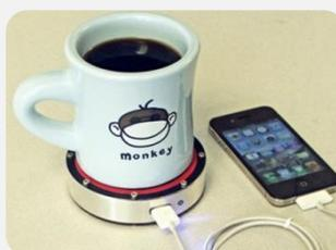
L'Epiphany onE Puck permet de recharger son smartphone grâce à une simple tasse de café. Comment ce gadget résolument utile fonctionne-t-il ? C'est simple, on utilise un moteur Stirling (moteur à énergie externe) alimenté uniquement par
