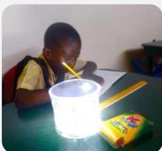
Conçue pour fournir de la lumière aux populations privées d'électricité ou victimes de catastrophes naturelles, la lumière LUCI est équipée d'une ampoule LED (Light Emitting Diode) capable de fonctionner pendant douze heures d'affilée après six heures de recharge au soleil.
