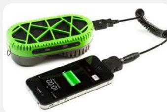
Une entreprise suédoise propose un boîtier qui permet de recharger les petits appareils électronique avec une cuillère à café d'eau. Le principe ? La pile à combustible.
