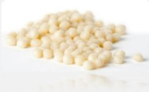
Proposé aux industriels sous forme de granulés, ce matériau est composé de fibre de cellulose qui remplace 20% à 50% des plastiques dérivés du pétrole.
